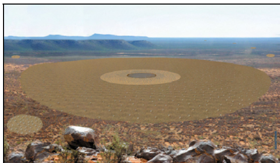
Au cœur de la zone centrale de SKA, d'un diamètre de 5 kilomètres, se trouvent les « tuiles » du réseau phasé. Entourant le réseau phasé, on peut apercevoir les rangées de paraboles, la zone la plus proche du réseau étant plus dense en paraboles que la zone externe. © SKA.
